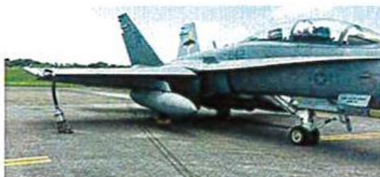
㊦飛行中の戦闘機内で本を読む乗員 ㊧2016年の事故後、右翼に給油ホースが引っかけたままのF A 18戦闘攻撃機＝いずれも米軍報告書より
